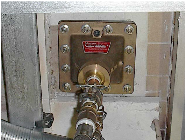
OXY-THERM® LE - Montage an einen Glasschmelzofen
